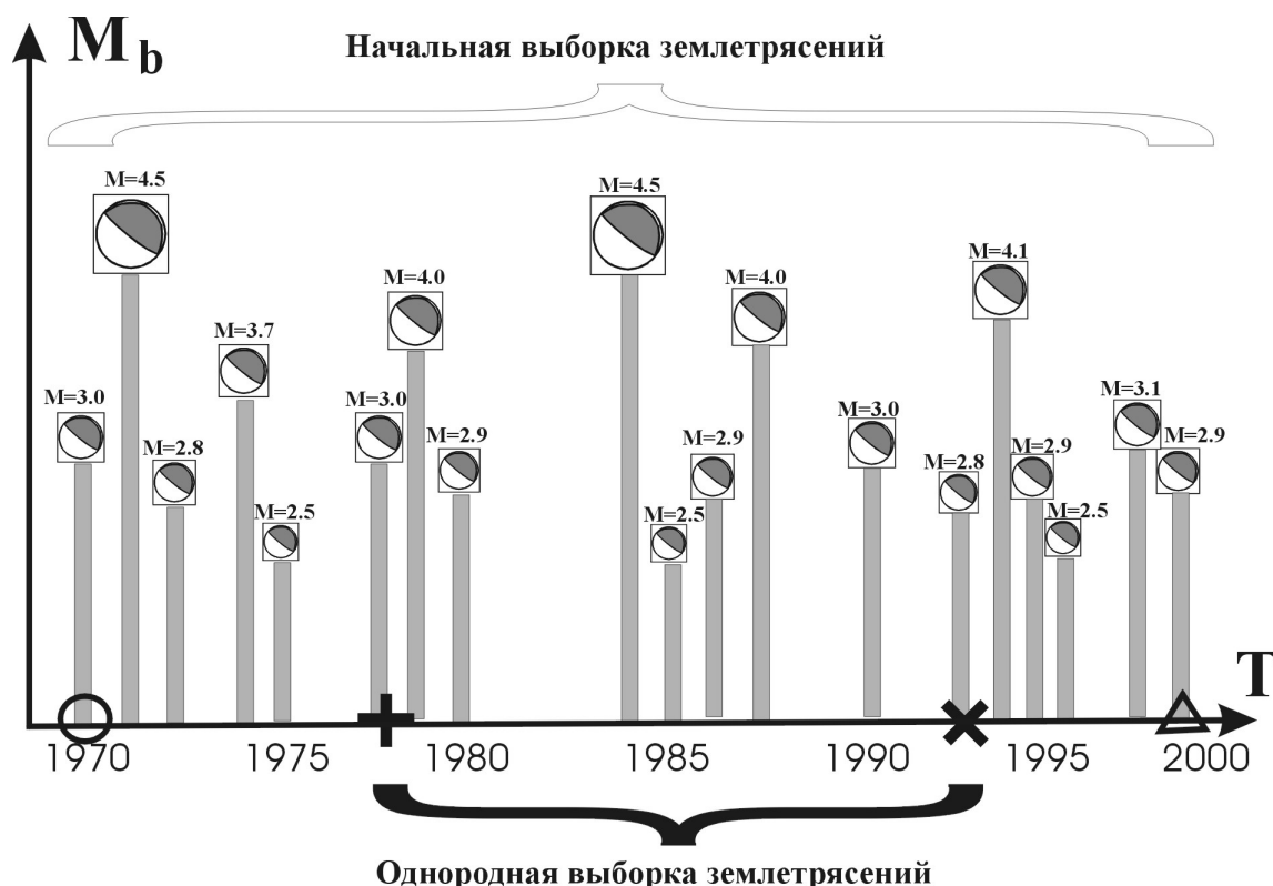
Рис. 3. Процедура создания однородной выборки механизмов очагов землетрясения (горизонтальная фигурная скобка) на основе начальной выборки (полный набор событий за весь период наблюдения, удовлетворяющих КП) состоящий в последовательной по шкале времени (горизонтальная ось) проверке событий на критерии МКА. Механизмы очагов показаны условно, прямой и косой крестик соответственно первое и последнее события в ОВЗ (их даты определяют временной период усреднения напряжений), кружком и треугольником показано соответственно первое и последнее события в НВЗ. Надписи на горизонтальной шкале соответствуют годам. См. пояснение в тексте.
