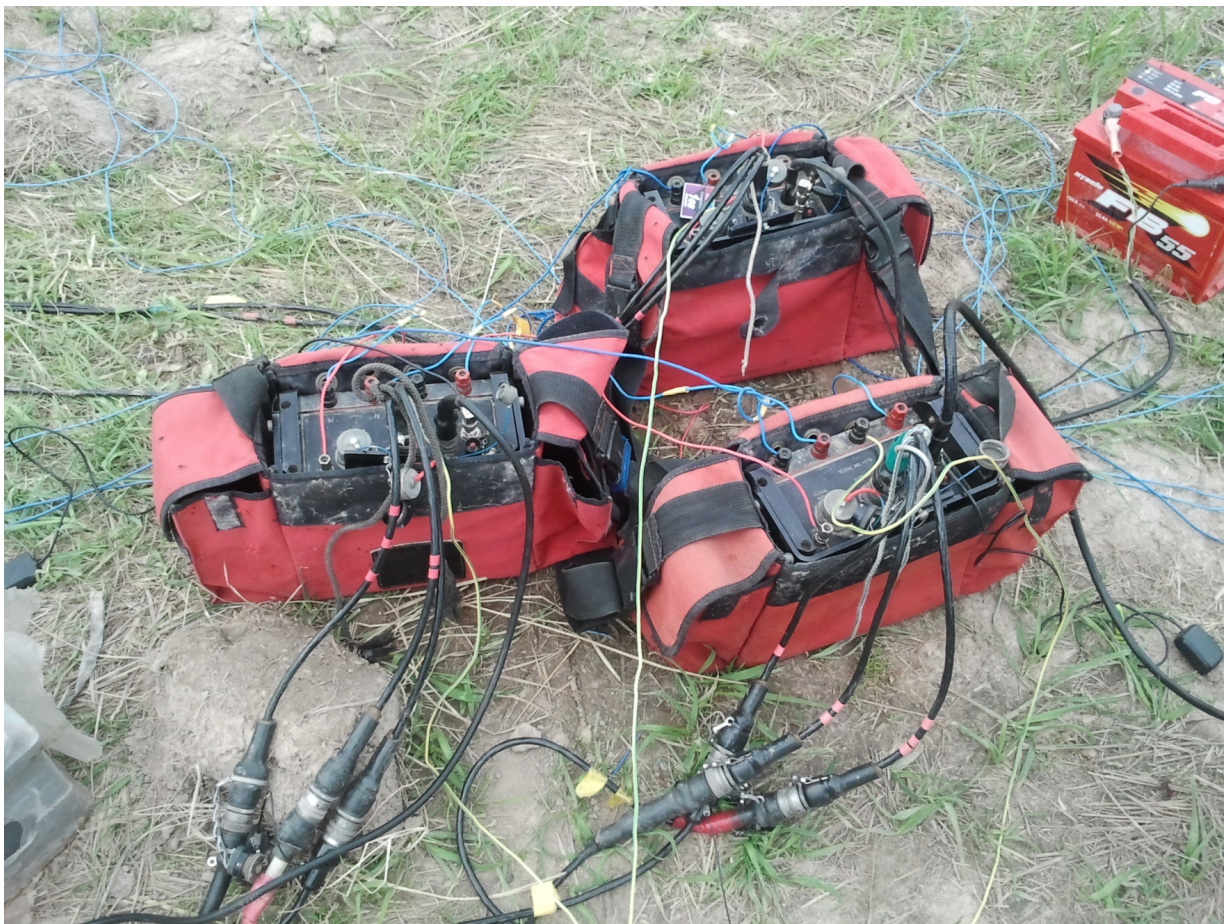
Рис. 2. Станции MTU-5A производства канадской фирмы «Phoenix Geophysics Ltd». Фото автора.
