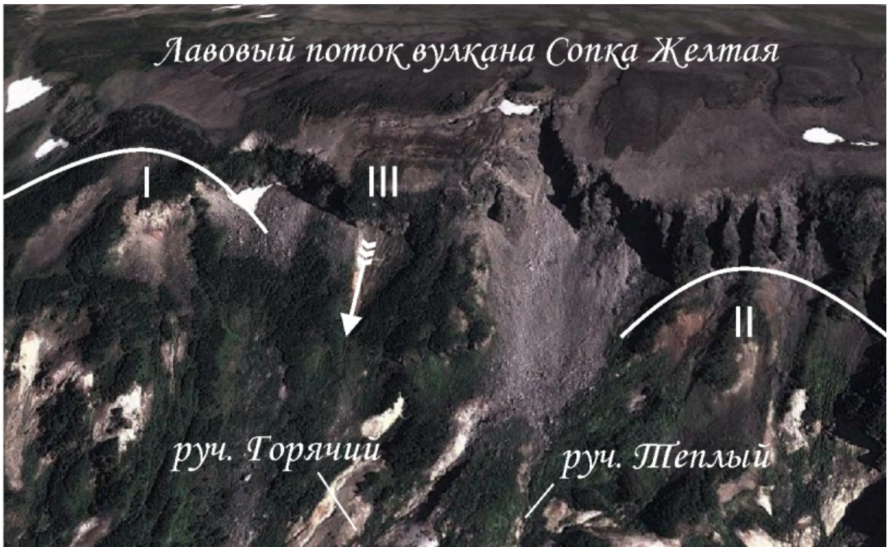
Рис. 5. Левый борт реки Гейзерной над ручьями Горячий и Теплый – налегание лавового потока вулкана Сопка Желтая на древние останцы, которые являлись упорами (I и II). Видно, что часть потока, разбитая трещинами (III), расположена между останцами – упорами и нависает над долиной. Стрелка показывает направление обвала, произошедшего 4 января 2014 г. (Google Earth, снимок 4 октября 2013 г.).
