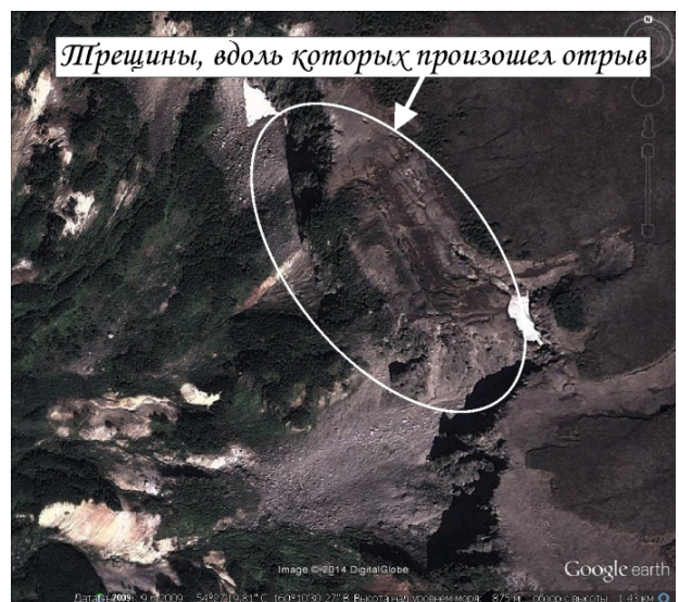
Рис. 4. Район, где произошел обвал – край лавового потока вулкана Сопка Желтая, нависающий над долиной реки Гейзерной. Видны многочисленные трещины, которые существовали уже давно (с 70-х годов XX в.) и свидетельствовали о неустойчивости блока, который обвалился (Google Earth, снимок 4 октября 2013 г.).
