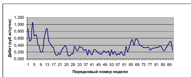
Рис. 5. Динамика дебита жидких нефтеотходов на шахтном лучевом дренаже.
