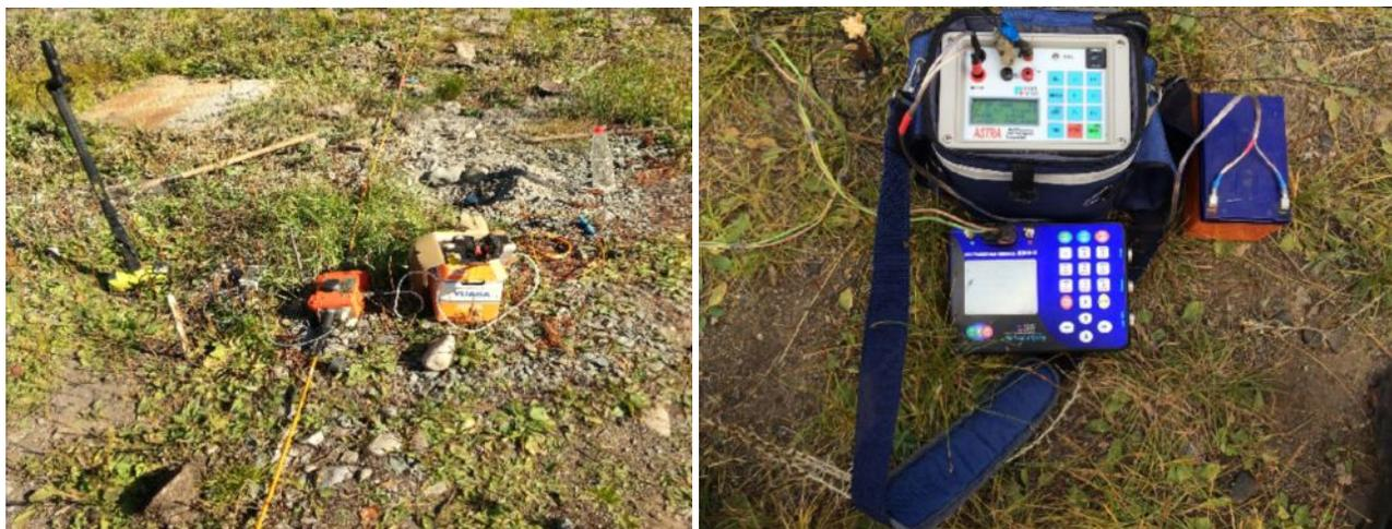
Рис. 4. Аппаратурный комплекс «ТЕЛСС-3» (слева) и электроразведочный генератор «Астра-100» с измерителем «МЭРИ-24» (справа).
