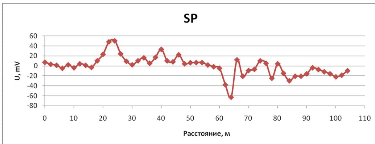
Рис. 9. График распределения потенциала естественного электрического поля.
