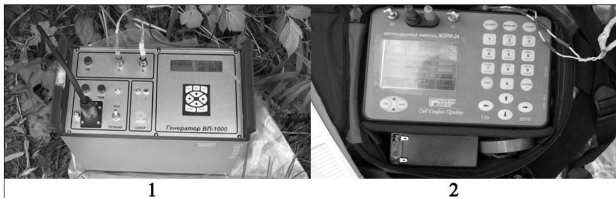
Рис. 3. Электроразведочная аппаратура: 1 – генератор ВП-1000, 2 – измеритель МЭРИ-24.
