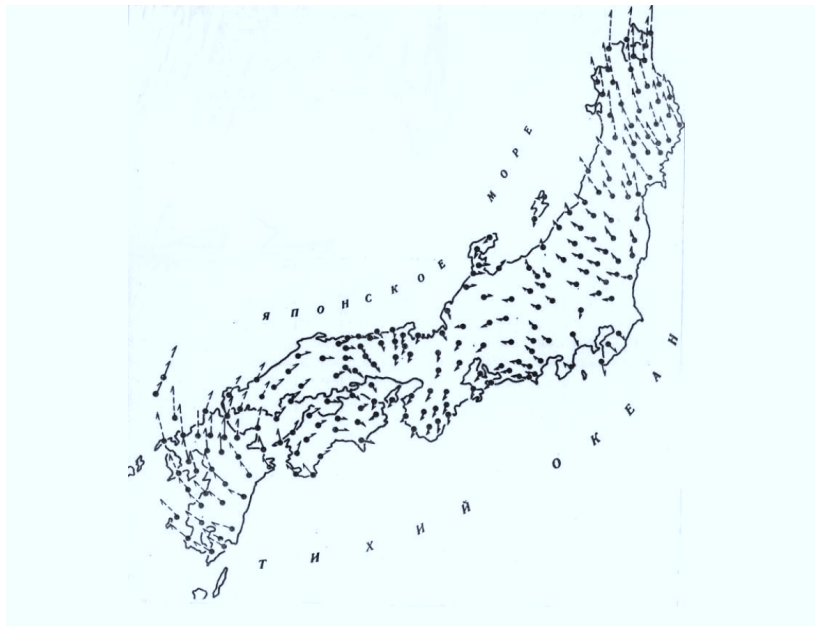
Рис. 4. Векторное изображение смещений триангуляционных пунктов I класса, полученных в результате двух периодов наблюдений в конце XIX - начале XX вв. и в середине XX в., отстоящих друг от друга приблизительно на 60 лет [8].
