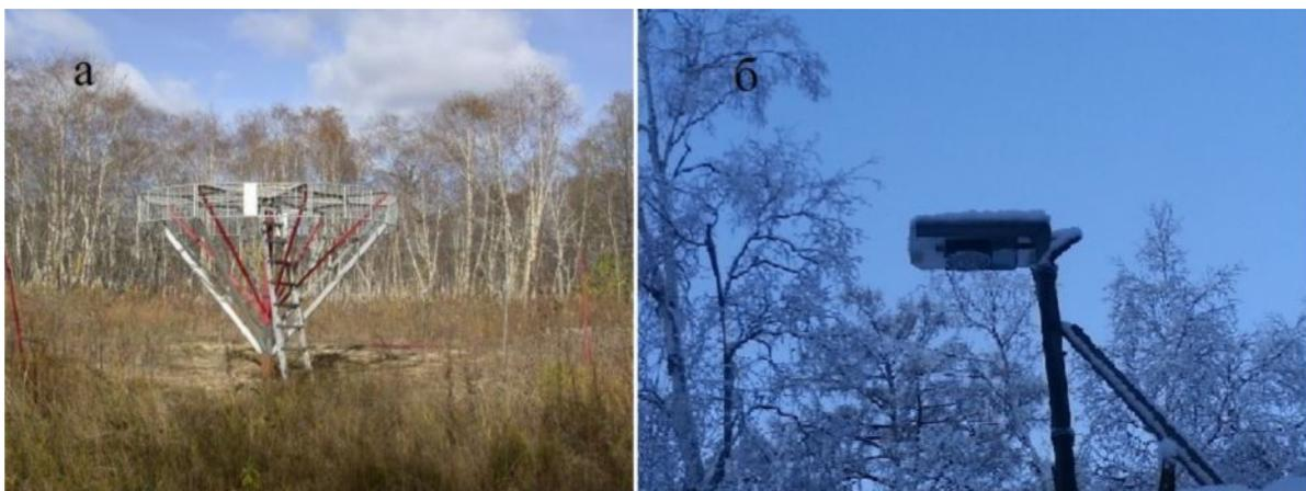
Рис. 2. Общий вид эквипотенциальной поверхности, на которой установлен флюксметр «Поле-2» на обсерватории ПРТ (а), флюксметр ЭФ-4, установленный в KZY обтюратором вниз (б).
