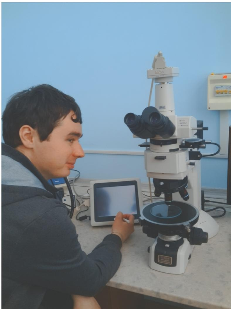
Рис. 3. Микроскоп Nikon Eclipse LV100 POL для исследования пород и руд в отраженном и проходящем свете, лаборатории вулканогенного рудообразования ИВиС ДВО РАН, месторождений полезных ископаемых КамГУ им. Витуса Беринга.
