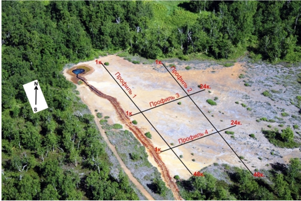
Рис. 10. Схема расположения сейсморазведочных профилей на термальной площадке Грифон Иванова.
