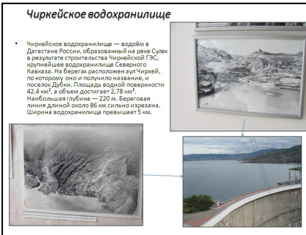
Рис. 6. Экскурсия на Чиркейское водохранилище. Высота плотины 232,5 м, длина по гребню 338 м.
