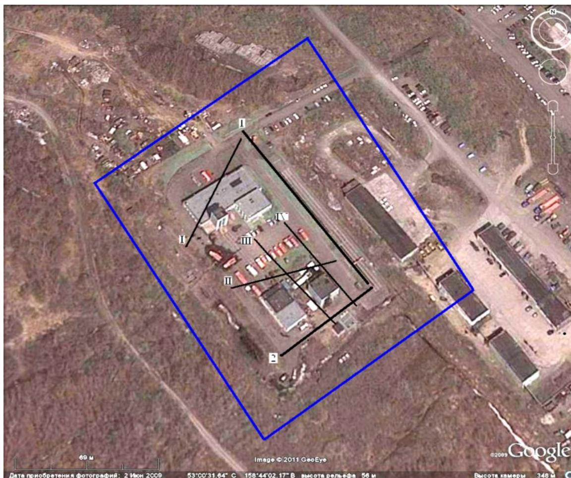
Рис. 1. Территория района работ (выделена прямоугольником). Тонкими линиями показано линии расположение буровых профилей (профили I, II, III и IV), толстыми – георадарных профилей (профили 1 и 2). Номера профилей расположены у пикета 0 м на линии каждого профиля.
