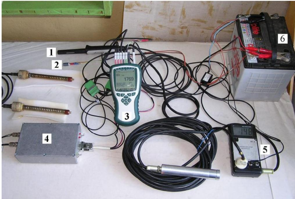
Рис. 2. Общий вид регистрирующего комплекта на базе ALMEMO 2690-8: 1 – датчик  $CO_2$ , 2 – датчик температуры, 3 – самописец ALMEMO 2690-8, 4 – двухканальный формирователь импульсов, 5 – водородный геофизический сигнализатор, 6 – аккумулятор.
