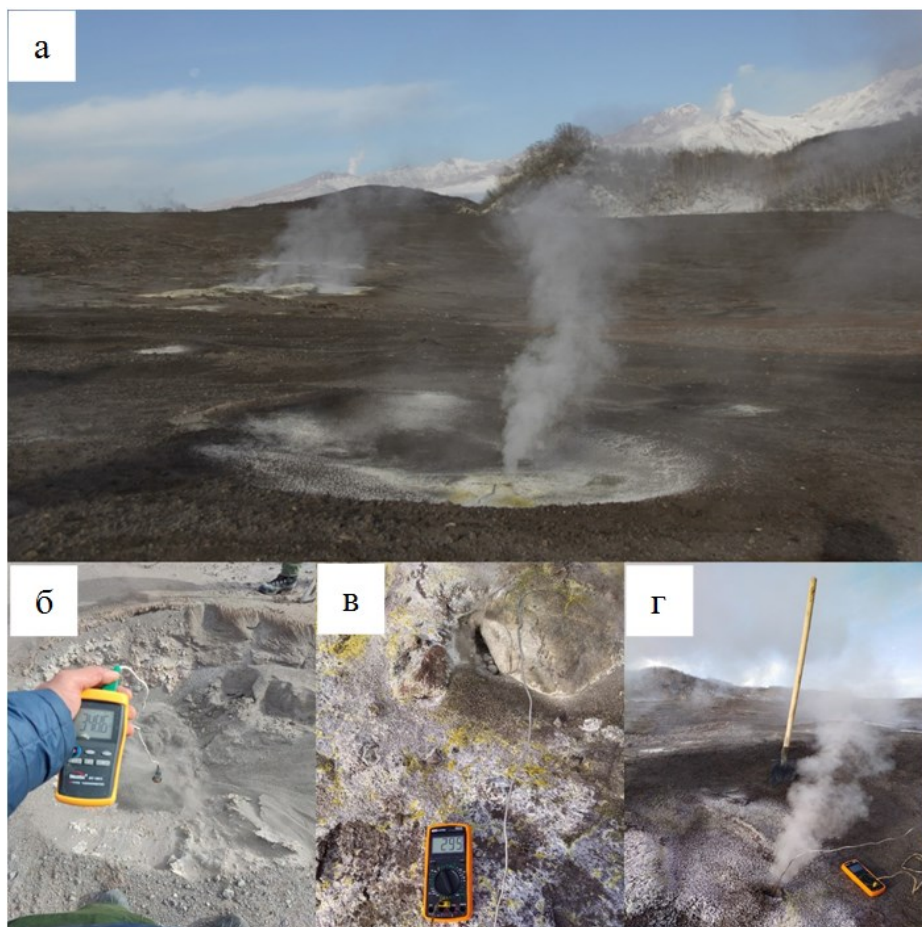
Рис. 2. Пирокластический поток извержения вулкана Молодой Шивелуч 11 апреля 2023 г.: а – пример пеплового котла с диаметром на поверхности приблизительно 1.5 м; б – измерение температуры в котле в середине сентября 2023 г., показания термопары – 358 °С; в – измерение температуры в котле в начале ноября 2023 г., показания термопары – 295 °С; г – пример пеплового котла с масштабом в районе долины реки Кабеку, 1 ноября 2023 г.
