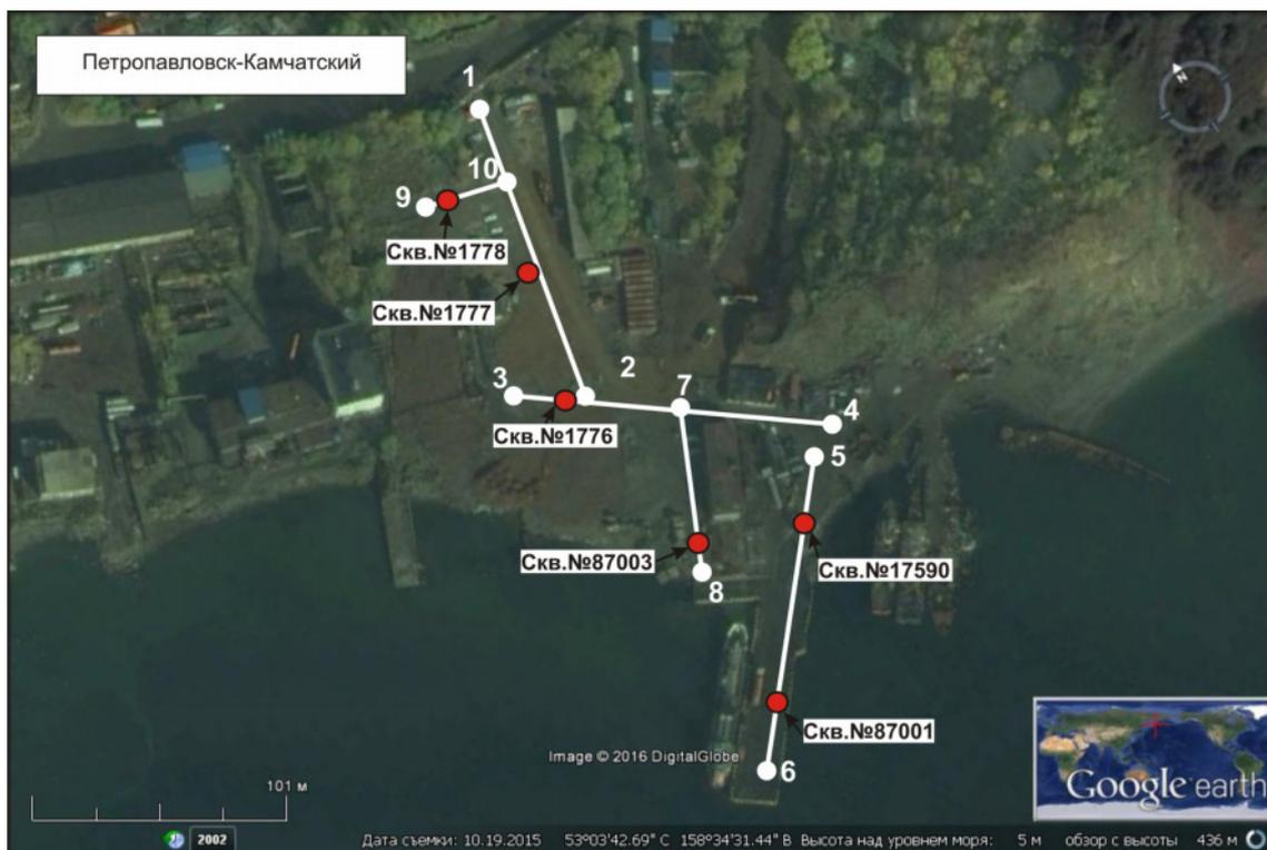
**Рис. 4.** Детальная схема района работ (космический снимок Image Landsat, Data SIO, NOAA, U.S. Navy, NGA, GEBCO [www.earth.google](http://www.earth.google)). Условные обозначения: 1-2 – георадиолокационный профиль 1; 3-4 – георадиолокационный профиль 2; 5-6 – георадиолокационный профиль 3; 7-8 – георадиолокационный профиль 4; 9-10 – георадиолокационный профиль 5; скв.№1778 и т.п. – скважина и ее номер.
