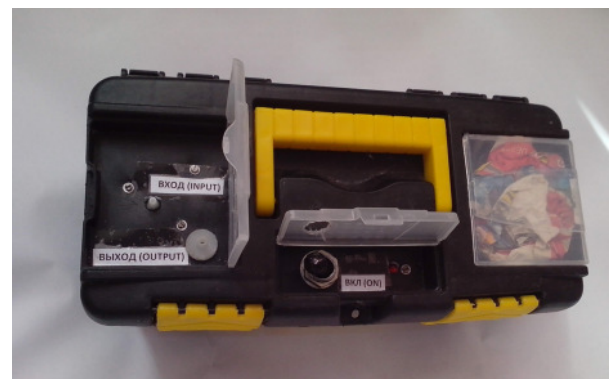
Рис. 1. Прибор с автономным питанием, для отбора проб газа и конденсата из фумарол. (изготовлен А. Ю. Поляковым)
