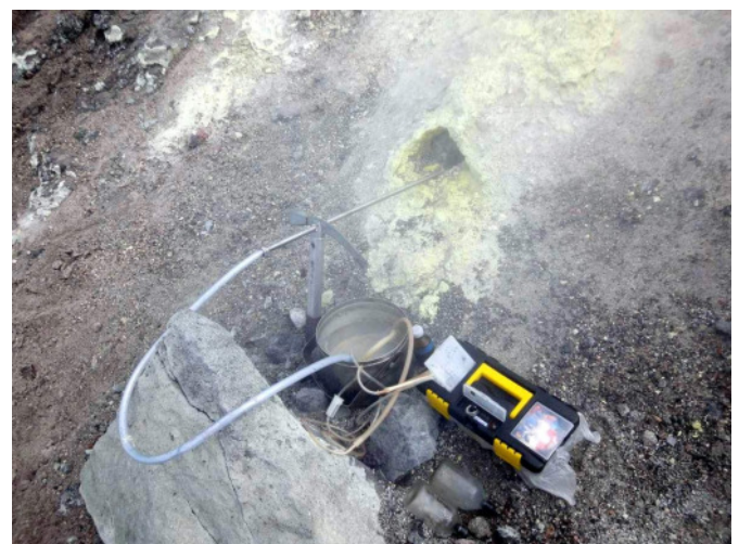
Рис. 2. Отбор проб газа и конденсата из фумаролы Авачинского вулкана
