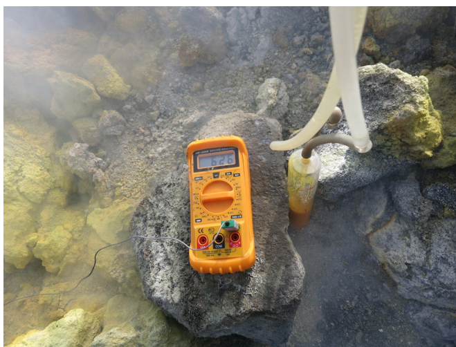
Рис. 3. Отбор газа и измерение температуры. 28 сентября 2013 г.
