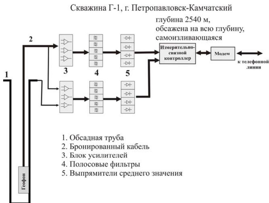
Рис. 1. Структурная схема комплекса для проведения электромагнитных измерений на пункте Г-1.
