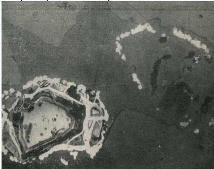
Рис. 78. Замещение пиритом магнетита. Скв. 11, глубина 1,40 м. Ув 320.
