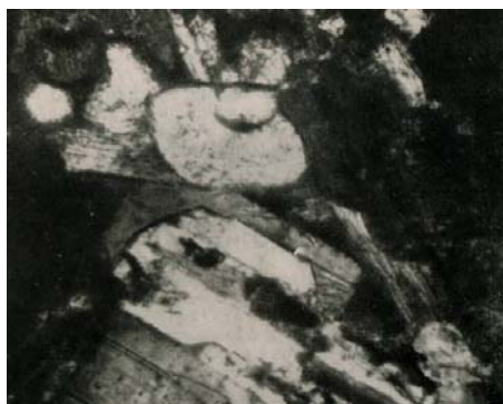
Рис. 58. Кайма адуляра вокруг вкрапленников плагиоклаза в пропилитизированном базальте. Ув. 200, ник+
