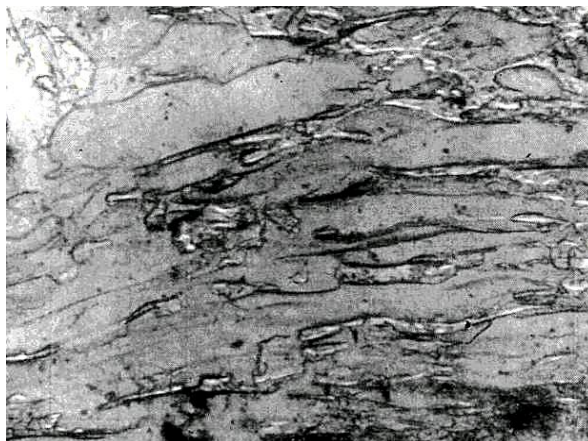
Рис. 48. Замещение пемзы монтмориллонитом и развитие клиноптилолита в порах. Ув. 400, ник, +
