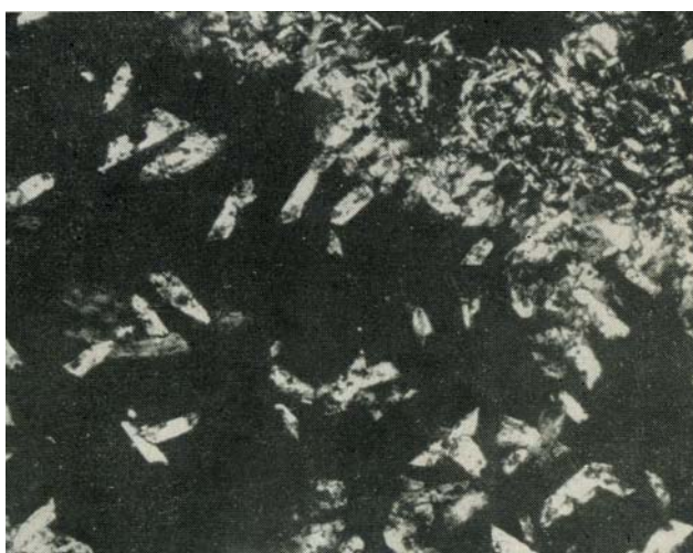
Рис. 52. Алуни́т в трещинах и пустотах отложений Центрального термального поля на глубине 2,5 м. Ув. 90, ник. +
