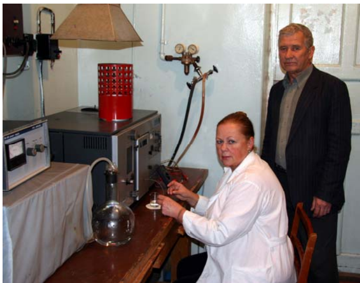
ст.н.с. А.М. Округина и ведущий инженер В.Ф. Луньков выполняют исследования с помощью атомно-абсорбционного спектрофотометра
