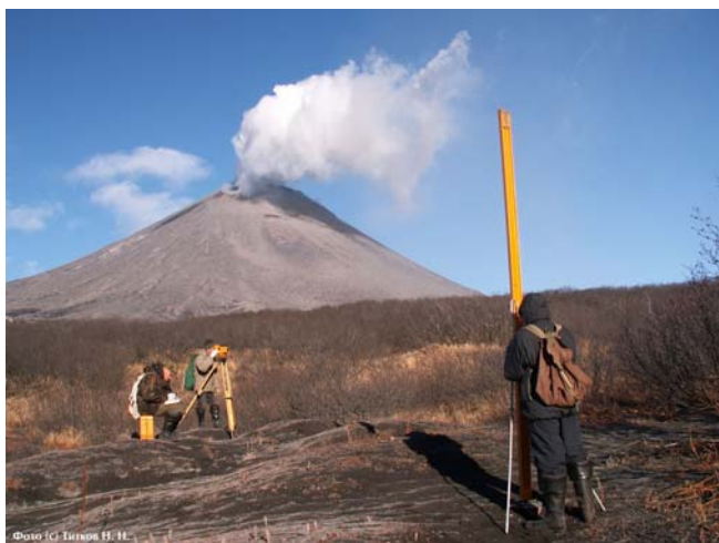
Нивелирование I класса. На заднем плане вулкан Карымский
