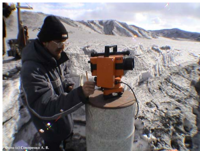
Наблюдения светодальномером СП-2 «Топаз»
