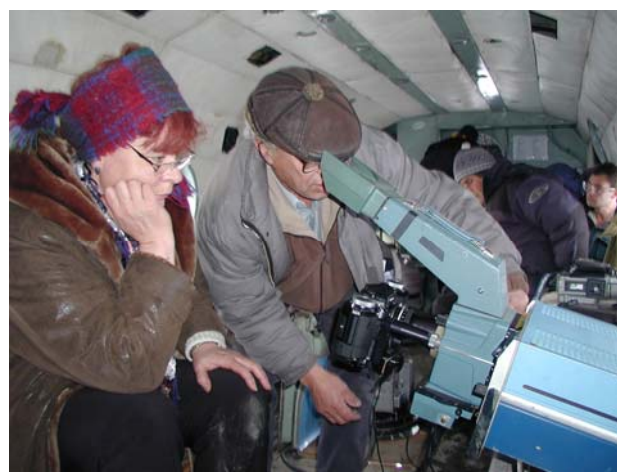
Проверка настроек инфракрасного пирометра АГА-680 перед аэросъемкой
