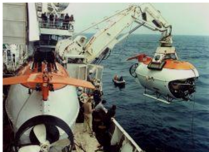
Рис.2.32. Спуск на воду глубоководного обитаемого аппарата «Мир» с борта НИС «Академик Мстислав Келдыш».
