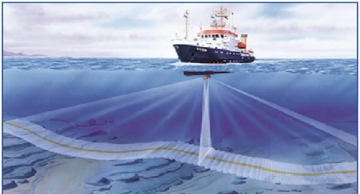
Рис.2.4. Схема работы многолучевого эхолота.
