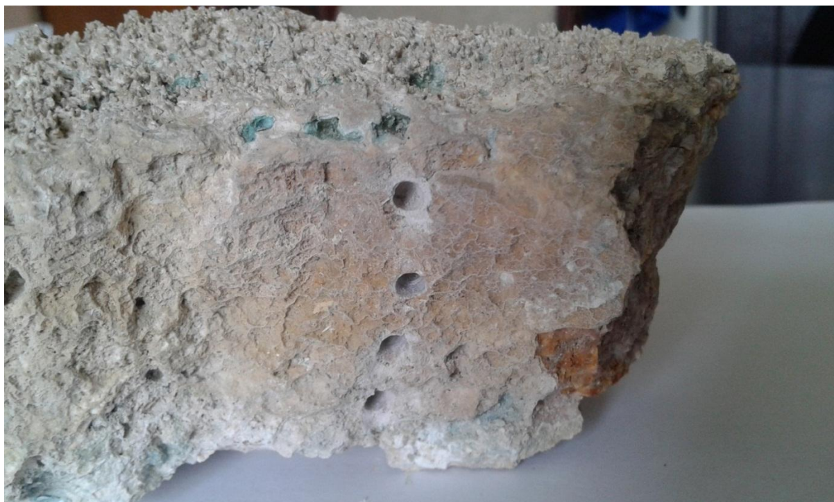
Рисунок 1 – Образец гейзеритового плаща гейзера Великан, с высверленными отверстиями для взятия проб; нумерация снизу вверх: 1 (нижняя часть образца, не видна на фото), 2, 3, 4, 5
