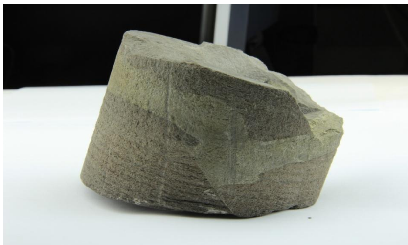
Рисунок 3 – Тектоническая трещина, заполненная мелкокристаллическим кальцитом
