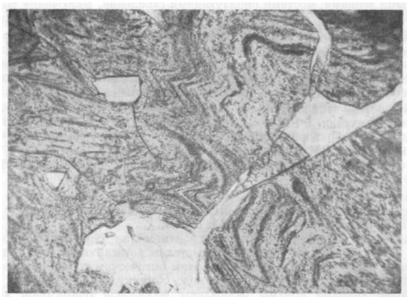
Фиг. 16. Липарито-дацит с флюидальной микроскладчатой структурой. Шл. 757; увел. 46; при одном николе.
