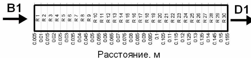
Рис. 2 Схематизация эксперимента и вычислительная сетка, используемая для численного моделирования закачки щелочного раствора  $\text{NaNO}_3\text{-NaOH}$  в образец песчаной породы. B1-элемент, в который осуществляется инъекция щелочного раствора, D1 – элемент выхода раствора из образца.
